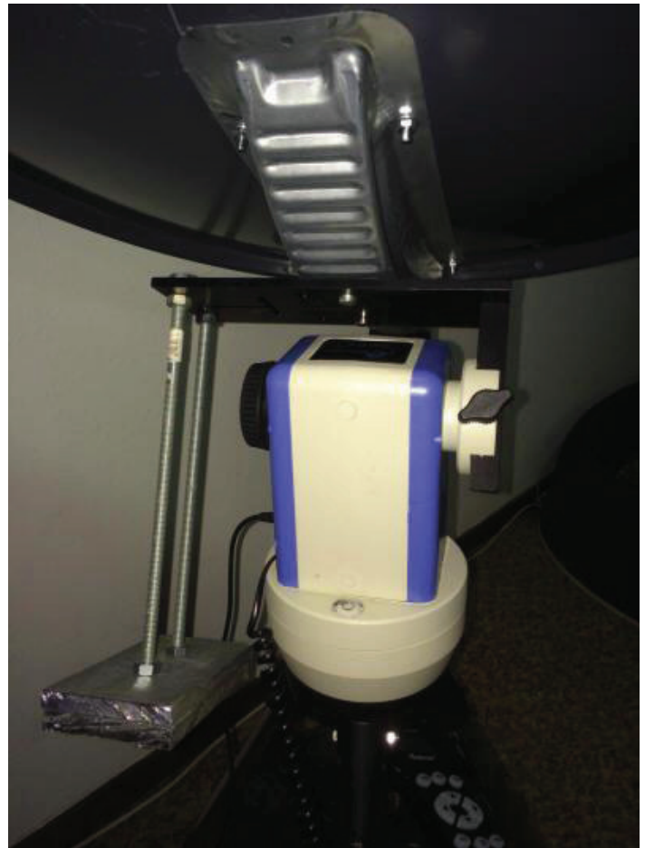
Mechanische constructie om de schotel aan de gearbox te bevestigen .
